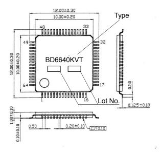
TQFP64V outlines (Unit : mm)
