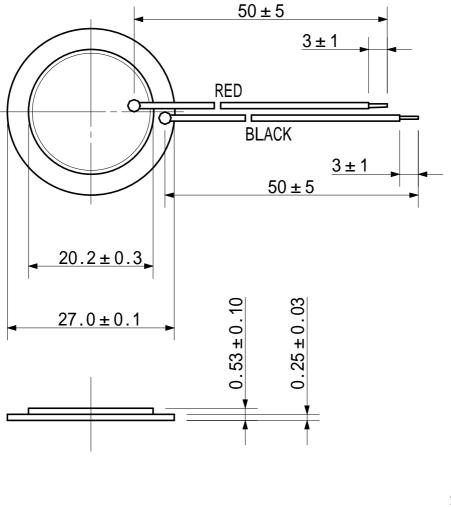
1) Metal:Brass2) Ceramic:KPM-313) Electrode:Silver4) Leads:AWG-325) Unit:mm
